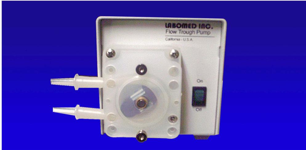
Des actions accréditées système pompe est fixe-vitesse, l'auto-amorçante pompe péristaltique. La pompe péristaltique roller pression comprime liquide par le tuyau. Le débit est proportionnelle à la vitesse des rouleaux (rpm) et le diamètre intérieur de la tubulure). La pompe peut être utilisé pour liquide de la pompe ou de gaz sans contaminer la pompe; pompé matériel contacts le tube seulement. Labomed, Inc. est certifié par l'ISO-9001-2000, a este Conformité et est FDA sous licence.
